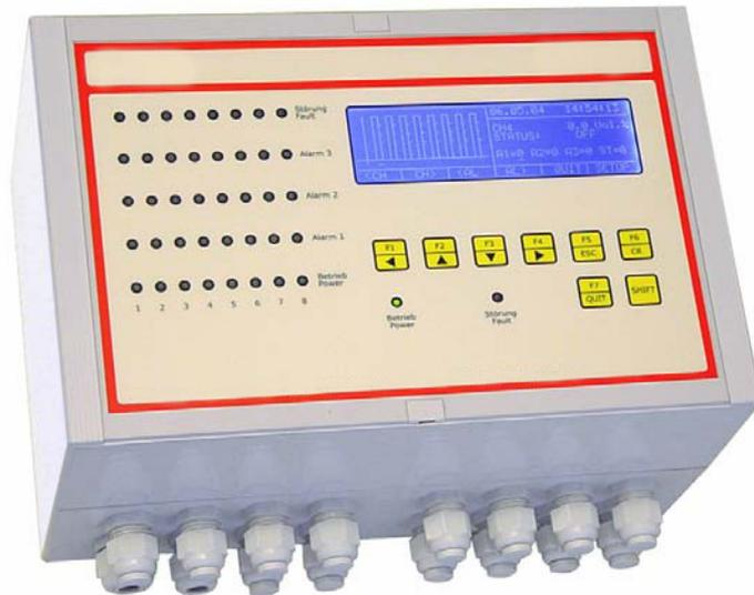
Beschreibung : Gaswarnzentrale zur Messung brennbarer und/oder toxischer Gase sowie Sauerstoff. Grafikdisplay. 3 Alarmschwellen pro Kanal. 24 frei konfigurierbare Relais. 8 Analogausgänge.
